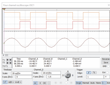
Рис. 3. Осциллограммы сигналов на входе/выходе трансформатора и на выходе выпрямителя (нижня)
