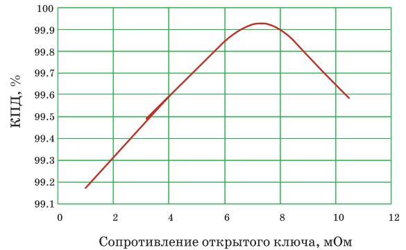
Рис. 12. Зависимость КПД выпрямителя от сопротивления открытого идеального ключа
